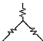
CONEXION DE ESTRELLA STAR CONNECTION CONNEXION EN ETOILE STERN-SCHALTING COLLEGAMENTO A STELLA
